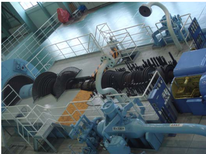
発電機を動かす蒸気タービンのカットモデル
