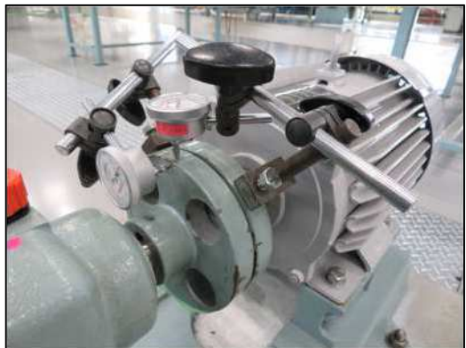
センタリング実習により、計測・修正作業に関する知識・技能を習得
