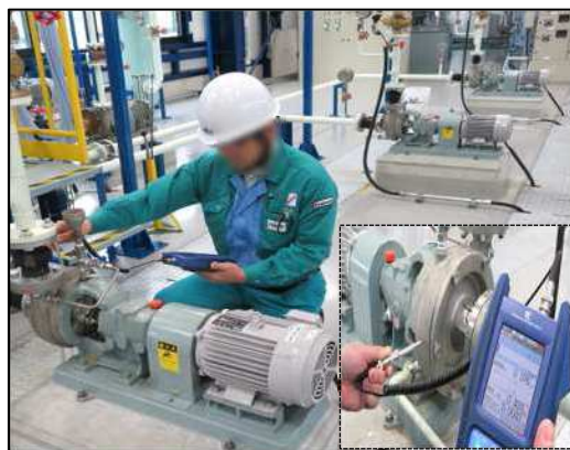
実機ポンプによるトラブル状態の体験とF T図作成により、要因特定に関する知識・技能を習得
